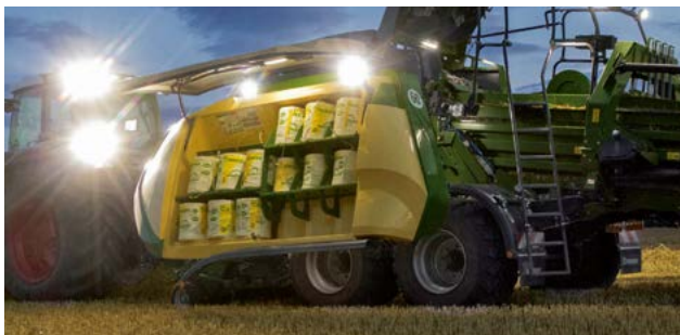
Beleuchtung in den Garnkästen
