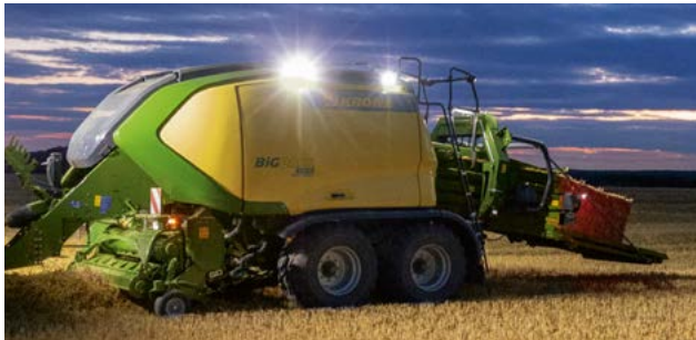
Arbeitsbeleuchtung auf den Garnkästen
